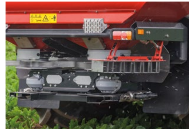
Turniketový, hydraulicky ovládaný hraniční deflektor ExactLine ohraničí rozmetání k okraji pole
