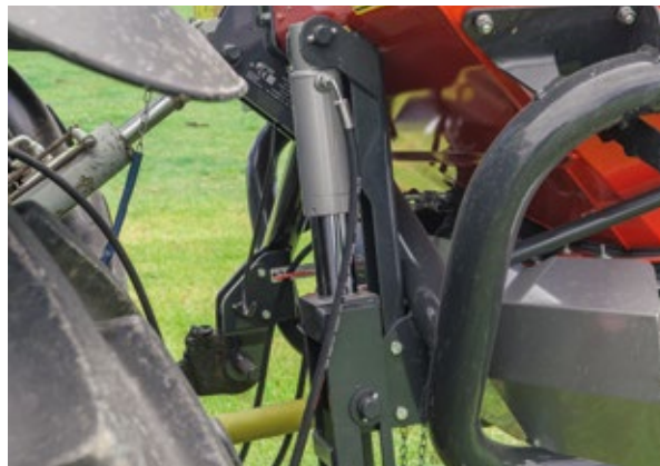
Hraniční rozmetání náklonem rozmetadla pomocí hydraulického pístu při jízdě v kolejovém řádku
