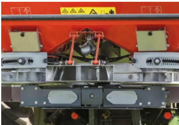
Deflektor pro rozmetání jedním kotoučem, kdy první jízda je jízda u kraje pole
